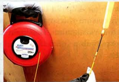
Kati-Blitzin kelapaketin sisältä löytyy mm. erilaisia kierrellyksin varustettuja kiinnityspäitä ja vetosukkapää, josta voi olla hyötyä heikkovirtajärjestelmien johtoja putkeen vedettäessä. Soikiopää sujahti putkeen ongelmitta.
