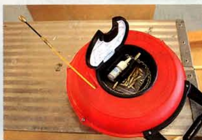
Kati-Blitzin kelapaketin sisältä löytyy mm. erilaisia kierrellyksin varustettuja kiinnityspäitä ja vetosukkapää, josta voi olla hyötyä heikkovirtajärjestelmien johtoja putkeen vedettäessä. Soikiopää sujahti putkeen ongelmitta.
