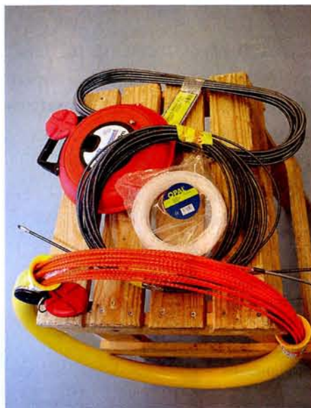
Testatut vetojouset ylhäältä lukien: Vetari, Kati-Blitz, KM 88, Opal ja Supersnake.
