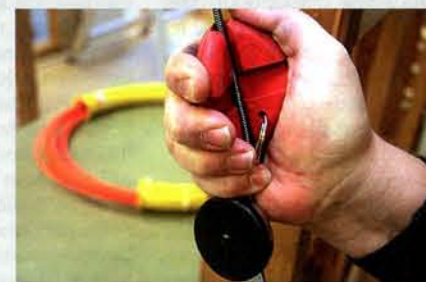
Kati-Blitzin ja Supersnaken paketin mukana tullut jousitarrain helpottaa kaapelin vetoa ja suojaaa lialta.
