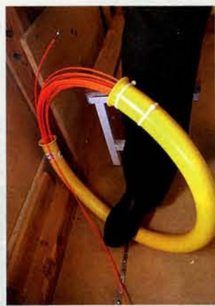
Supersnaken jousi purkautui ulos kelausputkesta vaivattomasti, kunhan putkea piti jalan alla pystyasennossa.
