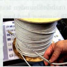
Kati-Blitzin kelapaketin sisältä löytyy mm. erilaisia kierrellyksin varustettuja kiinnityspäitä ja vetosukkapää, josta voi olla hyötyä heikkovirtajärjestelmien johtoja putkeen vedettäessä. Soikiopää sujahti putkeen ongelmitta.
